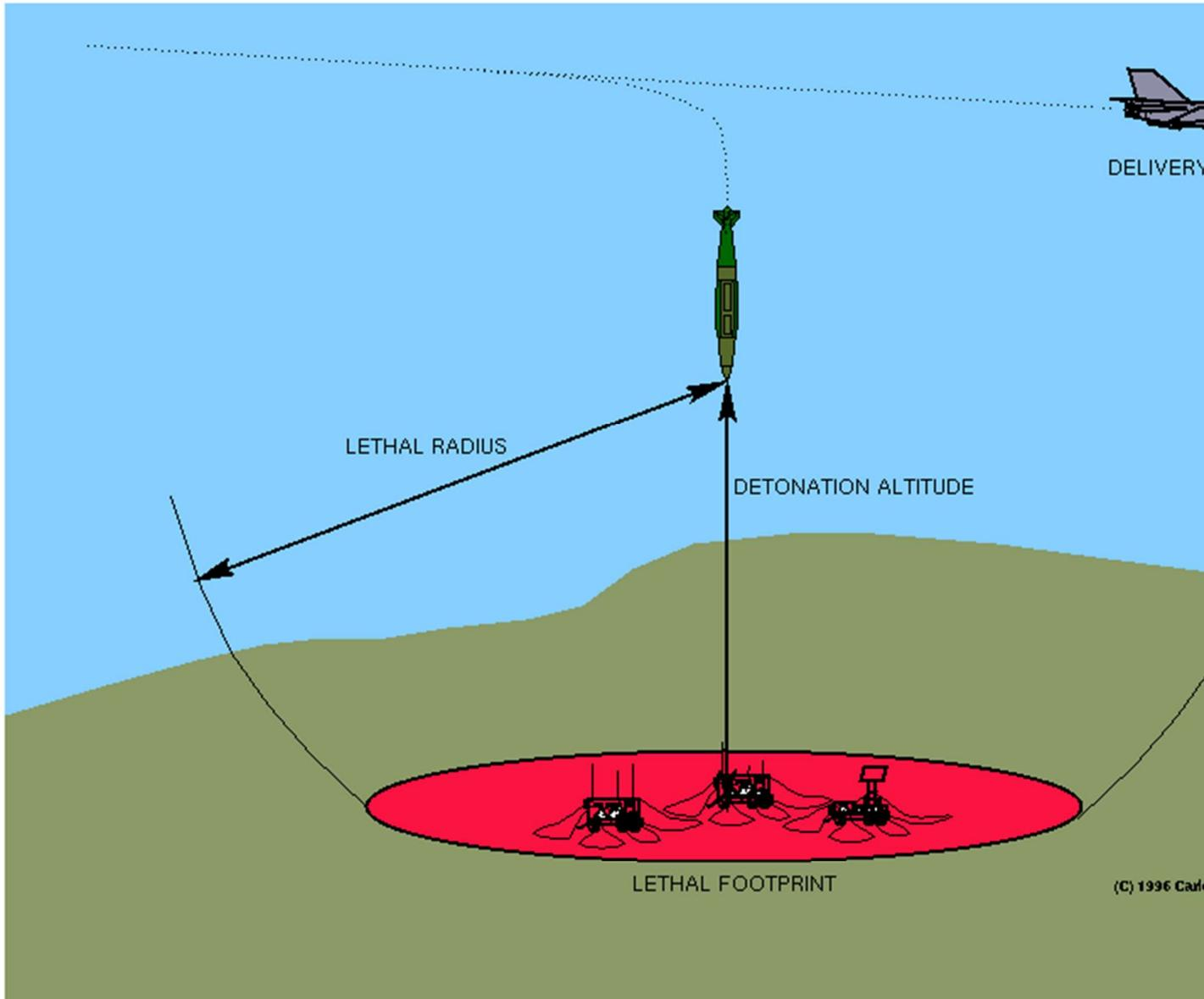
FIG.7 LETHAL FOOTPRINT OF LOW FREQUENCY E- BOMB IN RELATION TO ALTITUDE
