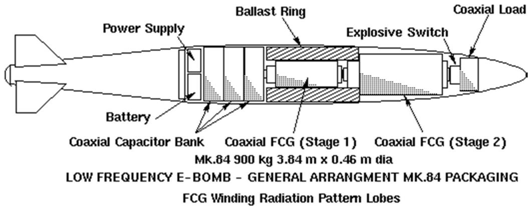
FIG.4 LOW FREQUENCY E-BOMB WARHEAD (MK.84 FORM FACTOR)
