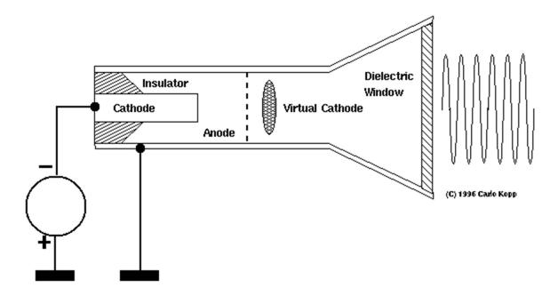
FIG.3 AXIAL VIRTUAL CATHODE OSCILLATOR
