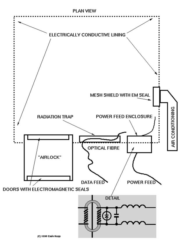
FIG.11 COMPUTER ROOM HARDENED AGAINST EM ATTACK
