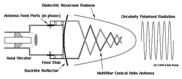
FIG.5.2 EXAMPLE OF VIRCATOR/ANTENNA ASSEMBLY
