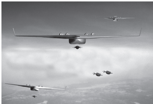
Figure 6. A gauche : module ravitailleur en vol d'UCAV d'un CAT. A droite : réarmement en vol d'un UCAV. (Préparé par Dennis Stewart et Isiah Davenport, General Dynamics, Advanced Information Systems.)
