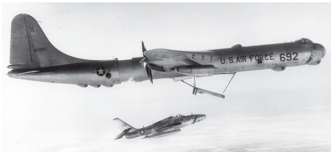
Figure 4. L'aéronef transporteur. Au début de la Guerre froide, la US Air Force avait besoin d'un avion de reconnaissance qui pouvait atteindre des cibles à l'intérieur du territoire soviétique avec une rapidité et une manoeuvrabilité qui lui permettrait d'évader les défenses soviétiques. Le projet d'un aéronef transporteur (FICON) offrait une solution en utilisant le RB-36 intercontinental pour transporter un chasseur de reconnaissance, le RF-84. Cependant, le programme a été soudainement arrêté en janvier 1955 quand plusieurs avions avaient été endommagés en essayant d'engager le trapèze. ("Flying Aircraft Carriers of the USAF: Project FICON," Goleta Air and Space Museum , http://www.air-and-space.com/ficon.htm . Dave Menard via Brian Lockett. Reprinted by permission.)
