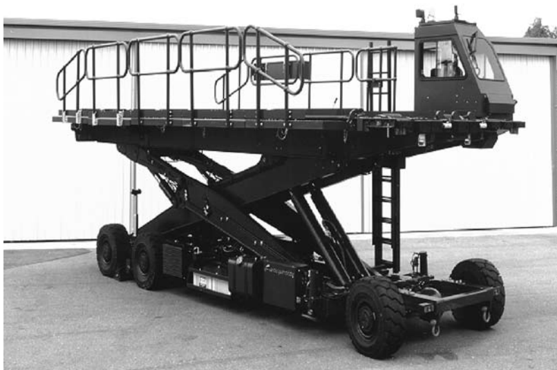
Figure 1. Chargeur léger de la prochaine génération. (Fabriqué par Static Engineering Pty, Ltd., Adelaïde, Australie.)
