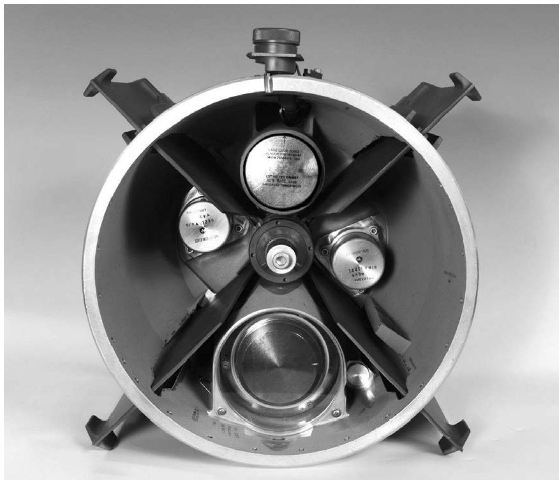
Figure 2. Mesureur inertielle à micro-système électromécanique. (Fabriqué par BAE Systems, Farnborough, Hampshire, Royaume-Uni.)
