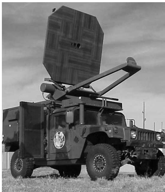
Un véhicule militaire modifié pour incorporer la technologie d'interdiction active, qui utilise un rayon d'énergie à ondes millimétriques pour créer une sensation de chaleur intense qui conduit les individus visés à reculer ou battre en retraite
