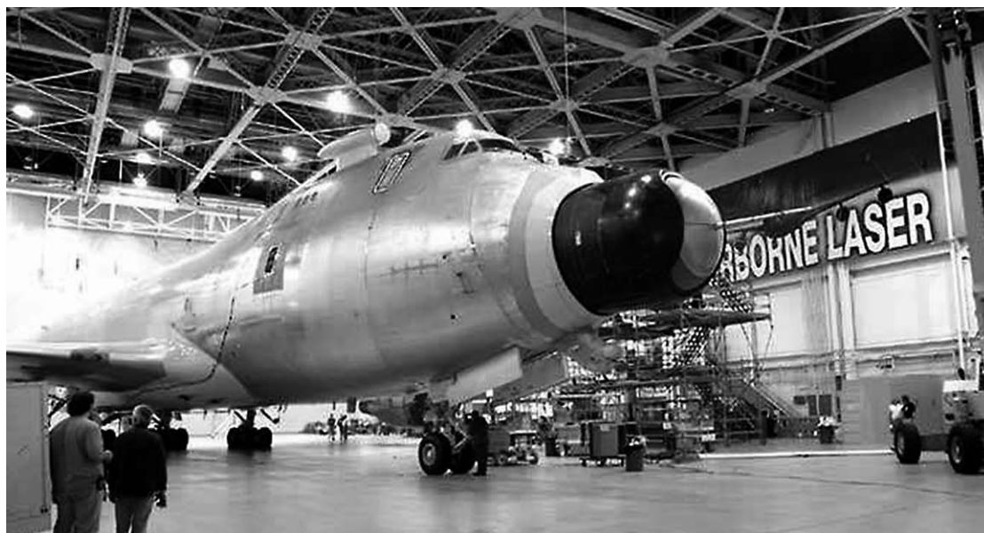
Le laser aéroporté : avion cargo 747-400 spécialement modifié, conçu pour abattre des missiles balistiques pendant leur phase de propulsion
