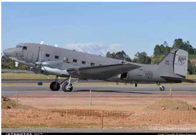
*Avión AC-47T "Fantom" de la Fuerza Aérea Colombiana pintado con tonos de gris de baja visibilidad. Se aprecian los motores turbopropelante incorporados en la modernización realizada por la empresa estadounidense Basler. También es visible el dispositivo FLIR bajo el morro del avión. Photo Copyright Zenon Sanchez Z publicada con permiso del autor.*
