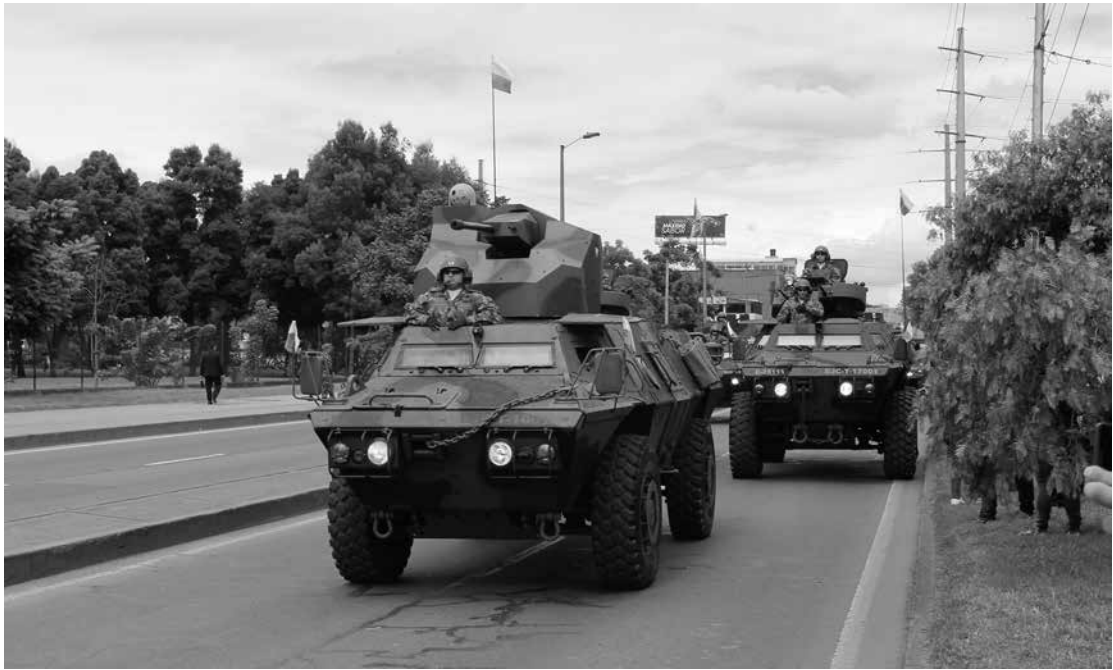
Prototipo nacional de ASV M-1117 dotado con una torreta especial blindada, dotada con un cañón de 20 mm. y dispositivo FLIR. La Caballería desea aumentar la potencia de fuego de los M-1117.
