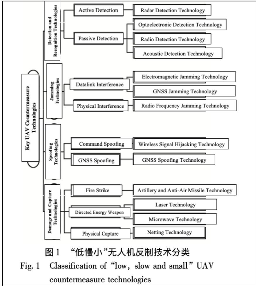
图 1 “低慢小”无人机反制技术分类
